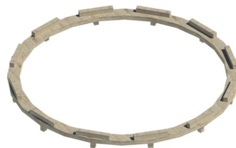
III. Inserisco tutti e 12 i pezzi del componente n. 5 all'interno dei fori del componente n. 3
