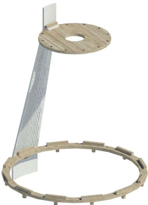
IV. Unisco il pezzo creato nel terzo passaggio con il pezzo creato nel secondo passaggio, incastrando il componente n. 5 all'interno del secondo foro del componente n. 2
